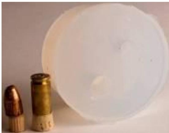
Le moule est prêt pour la réalisation du moulage en résine.
