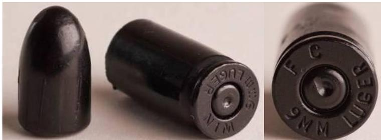
Les moulages sont prêts à être enregistrés sous la forme d'images balistiques ou à faire l'objet d'un examen et d'une comparaison au microscope.
