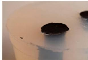
Placez le moule rempli de résine dans le pot sous pression et fermez le couvercle. Branchez le compresseur d'air sur le pot. Allumez le compresseur d'air et appliquez une pression de 2 bars dans le pot. Laissez la résine durcir pendant environ 2 heures. Respectez la durée exacte requise par le fabricant.
