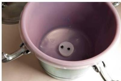
Fermez le pot sous pression et branchez le compresseur d'air. Allumez le compresseur d'air et appliquez une pression de 2 bars dans le pot.
