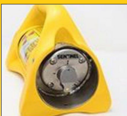
Figura 1 - Cámara gamma para radiografías (iridio-192 o cobalto-57)
