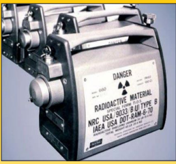
الشكل 4 - مولد محمول للتصوير الصناعي بالأشعة السينية
