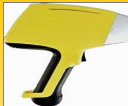
الشكل 6 - جهاز تحليل طلاء الرصاص (الكاديوم-109 أو الكوبالت-57)
