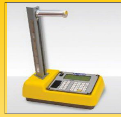
الشكل 2 - أجهزة قياس كثافة الرطوبة (الأمريسيوم -241/البريليوم و/أو السيزيوم -137)
