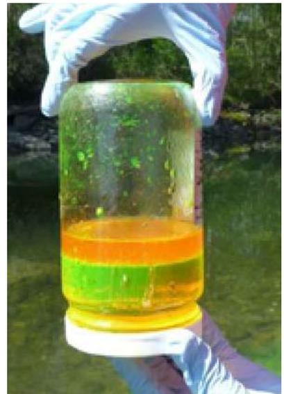
La muestra del líquido de los tambores es colocada en un frasco de vidrio para analizar los productos orgánicos. Una segunda muestra se puede ubicar en un frasco de vidrio claro para ver las diversas capas de productos químicos. Los residuos líquidos peligrosos más densos (generalmente orgánicos clorados) pueden estar ocultos bajo una capa inocua (a esto se le llama generalmente "cocktailing")
