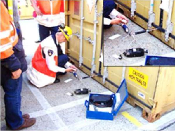
Búsqueda de gases tóxicos utilizando un detector de gases por fotoionización, antes de abrir un contenedor de envío. (Cortesía de la ILT de Países Bajos)
