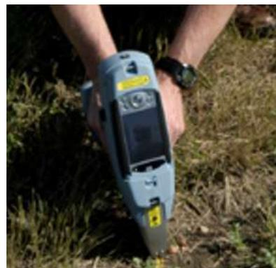
La toma de muestras puntual con un analizador de fluorescencia de rayos X portátil puede ayudar a determinar rápidamente las zonas contaminadas con metales. (Cortesía de la EPA de Estados Unidos)
