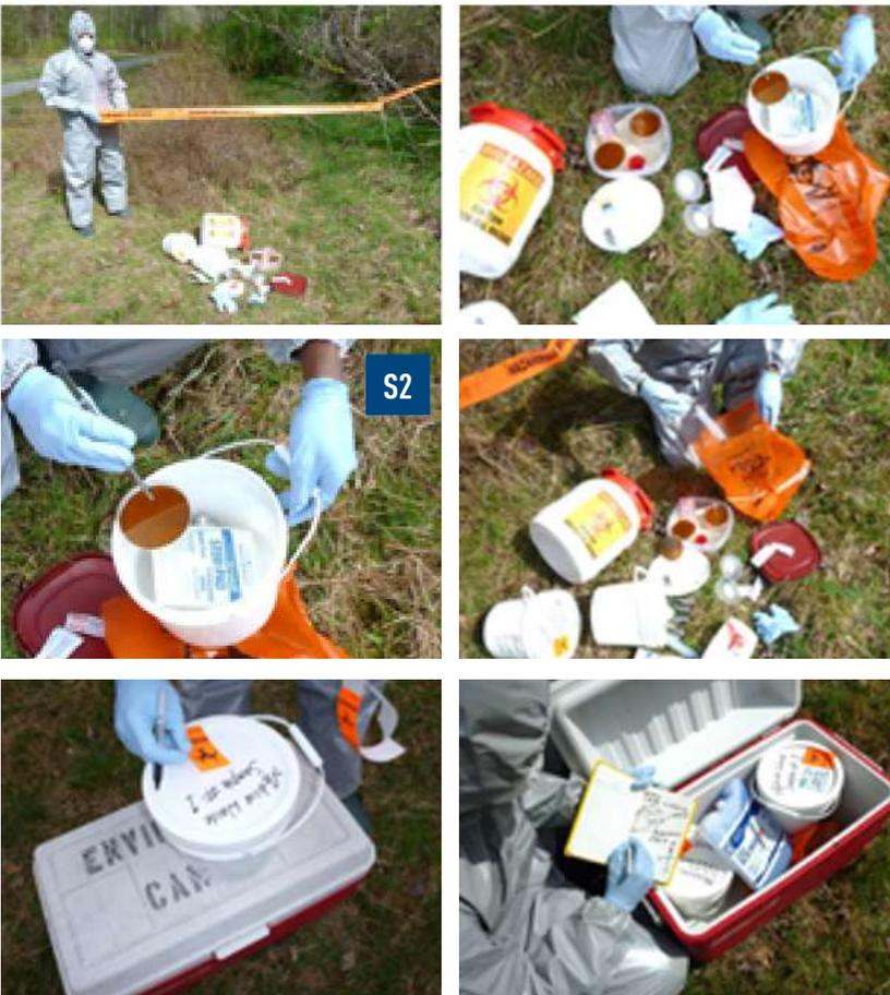
Utilizar pinzas grandes de acero inoxidable para recoger muestras de residuos biológicos, jeringas o instrumentos afilados. Almacenar en recipiente de plástico transparente resistentes a las perforaciones o en baldes de plástico de boca amplia que puedan sellarse, o tomar fotografías para atestiguar su presencia.
