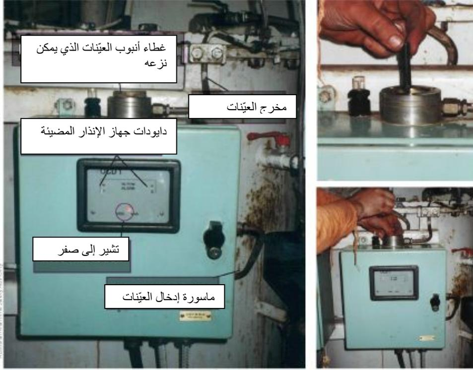
35، 36، 37. نماذج عن أجهزة استشعار وإنذار (15 ppm). وتظهر الصور على اليمين اختبار جهاز الإنذار عبر فكّ برغي الغطاء، ووضع شيء داخله لمنع دخول النور، بحيث ينطلق الإنذار وأداة الإيقاف. انتبه إلى أن صانع الجهاز لم ينصح بوضع أشياء صلبة داخل أنبوب العيّنات. ولم يثبت الاختبار أنه جرت معايرة الجهاز بشكل صحيح.
